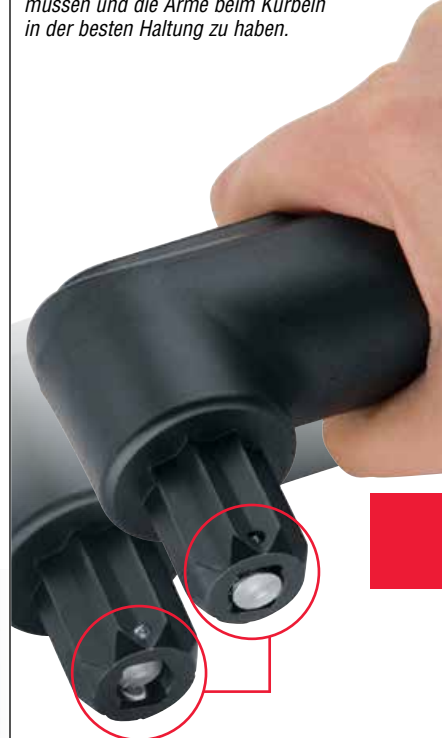
Der patentierte Verschlussmechanismus besitzt zwei Edelstahl Pins, welche sich automatisch zurückziehen, sobald der Auslösemechanismus betätigt wird. Wird der Verschlussmechanismus losgelassen, fahren die beiden Pins wieder aus, um eine solide und sichere Arretierung sicher zu stellen.
