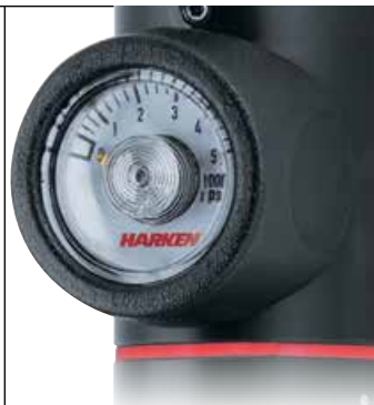
Eine leicht ablesbare, analoge Druck-Anzeige, in vier Stellungen fixierbar, ist gut aus dem Cockpit abzulesen. Druck-Anzeige inkremental 0-5 (0 - 5000 psi / 0 - 345 bar).
